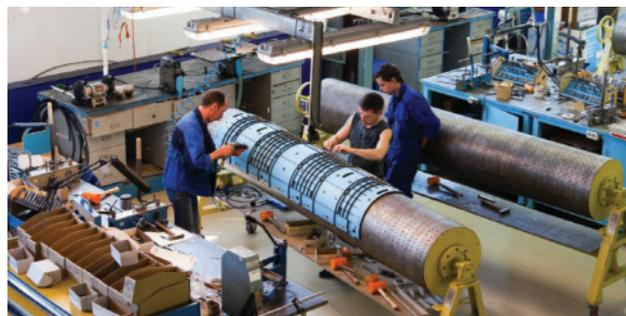
Производство ротационных станцевых форм
