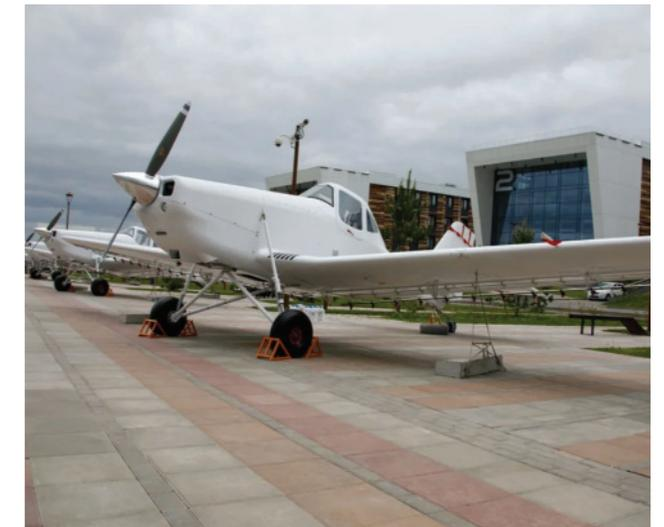
Композитные конструкции планера для авиационного комплекса сельскохозяйственного назначения (Т-500)
